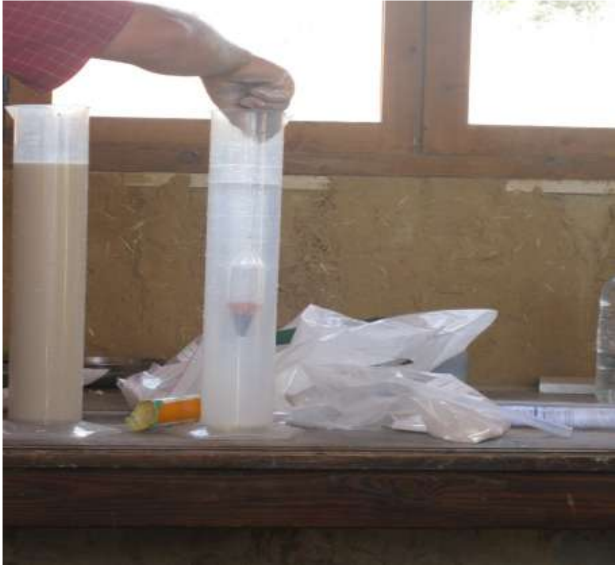
Figure 3: sédimentométrie de la terre brune à pisé
