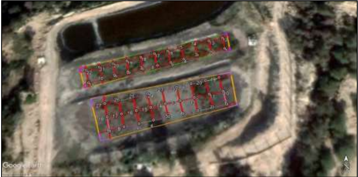
Figure 12. Carte du maillage adopté pour la prospection électrique des deux filtres végétalisés
