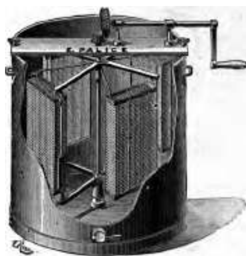
FIG. 30. — Mule-extracteur centrifuge perfectionné, à cages tournantes.
