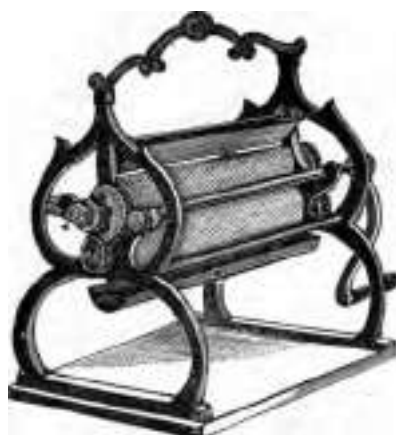
FIG. 61. — Machine Dunham pour fabriquer la cire gaufrée.
