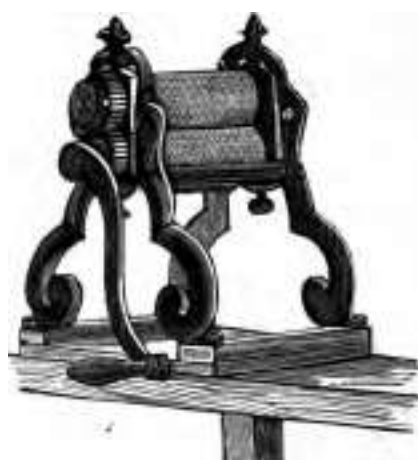
Fig. 61. — Machine Vandersart pour fabriquer la cire gaufrée.
