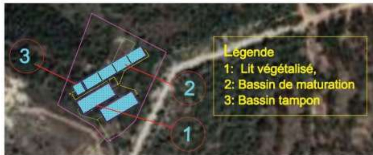
FIGURE 8. VUE D'ENSEMBLE DES OUVRAGES DE POST-TRAITEMENT
